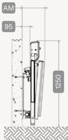
Eingeklappte Plattform mit Wandbefestigung
