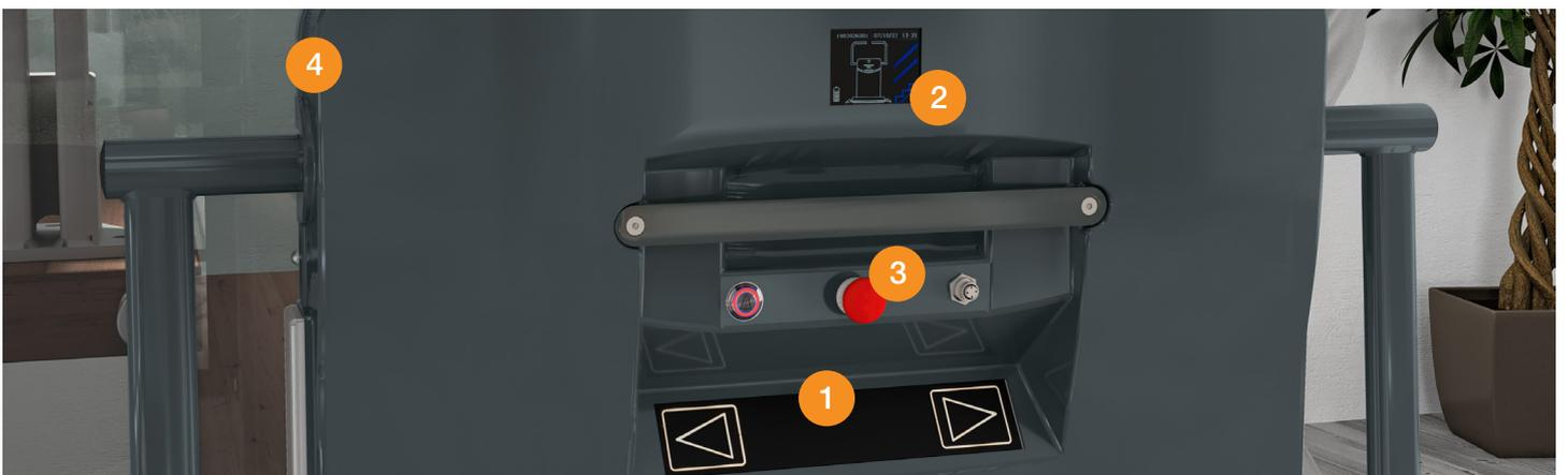
1. Durch das **Touch-Bedienpaneel** kann man der Lift von Bord ergonomisch bewegen, indem man einfach mit den Fingern oder der Handfläche die Leuchtrichtungspfeile berührt, ohne Druck machen zu brauchen.
