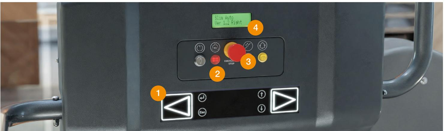
1. Durch **das Touch-Bedienpaneel** kann man den Lift von Bord ergonomisch bewegen, indem man einfach mit den Fingern oder der Handfläche die Leuchtrichtungspfeile berührt, ohne Druck machen zu brauchen.
