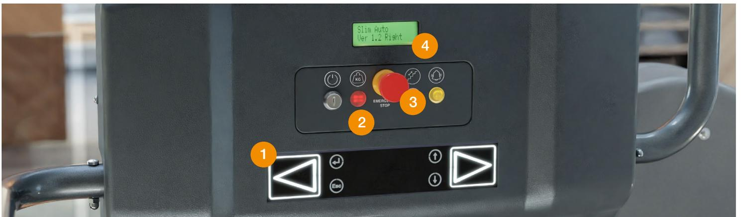
1. La **boîte à boutons Touch** permet le mouvement ergonomique à bord, en appuyant les doigts ou le paume de la main sur les flèches lumineuses de montée/descente, sans besoin d'exercer aucune pression.
