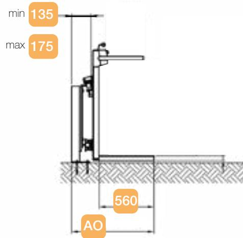
Eingeklappte Plattform mit Befestigung an die Wand
