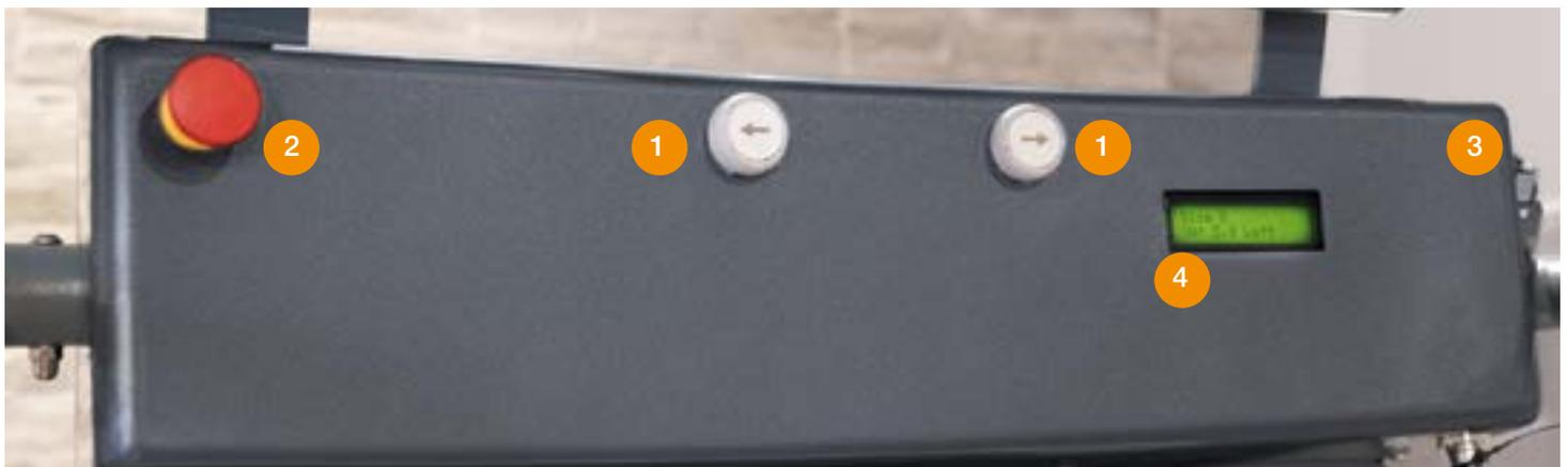
1. Die **Aufwärts- und Abwärtstasten** befinden sich in der Mitte des Bedienpanels der Plattform, wo der Benutzer sie leicht erreichen kann.
