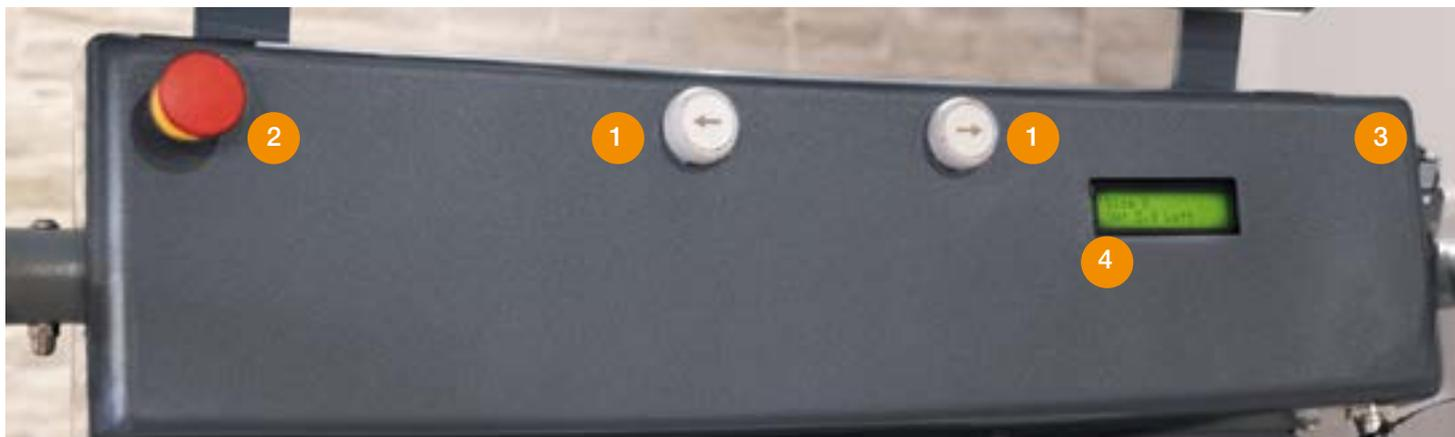
1. Les **boutons** de montée et descente sont placés au centre du panneau de commande.
